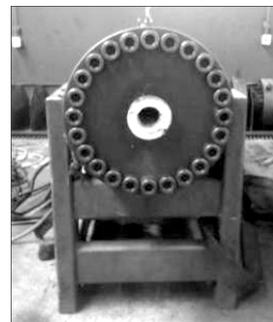
图 3 居中双层管柱试验中
