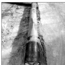
图5 偏心管柱挤毁形貌
