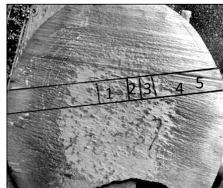
图 1 9Cr 连铸坯坯料取样位置示意
