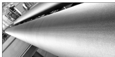
图 7 防腐前打砂后的焊缝两侧划痕区域
