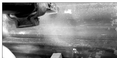
图 6 划痕位置的磁粉检测
