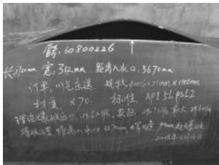
图 18 \Phi 1016 \text{ mm} \times 21.0 \text{ mm} 焊管爆破口全貌
