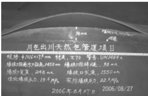
图 17 \Phi 1016 \text{ mm} \times 17.5 \text{ mm} 焊管爆破口全貌
