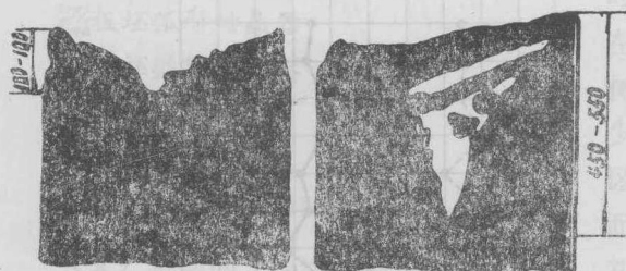
图3 用无底无冒口锭模浇铸的直径580毫米圆锭的缩孔深度和形状
