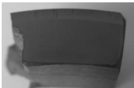
图 3 钻杆内螺纹接头表层摩擦热裂纹及摩擦热影响区形貌
