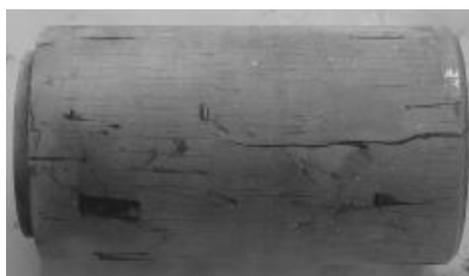
图 2 钻杆内螺纹接头热裂形貌
