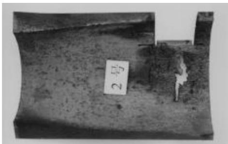
图 1 钻杆内加厚过渡带部位腐蚀疲劳裂纹形貌
